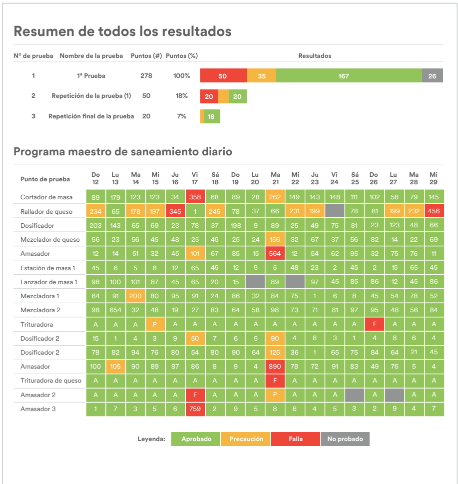
Figura 8. Software de tendencias de datos para evaluar la consistencia de la limpieza
